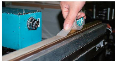
■ヒートシール機のヒーター被覆。豊富な規格サイズからヒーターの幅に合ったテープをお選びいただけます。
